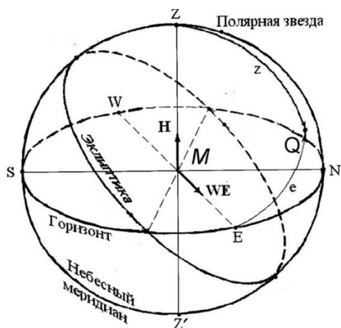
Рис. 7. Горизонтальная астрономическая система координат (ГАСК). М – точка наблюдения на поверхности Земли, S,W,N,E – точки юга, запада, севера, востока, соответственно, Z, Z' – точки зенита и надира, на большом круге небесной сферы SZNZ' (главный вертикал) происходят верхние кульминации небесных тел.
